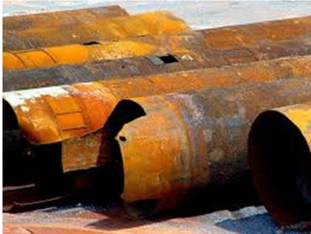
Слика 1: Општа корозија
