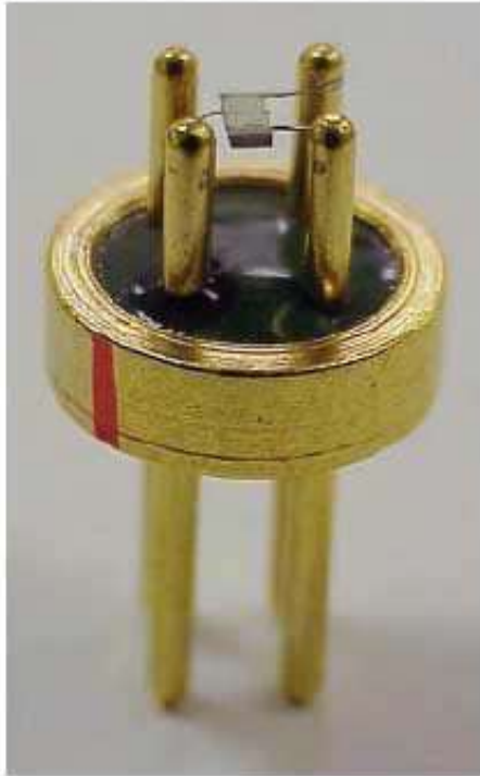
Slika 1. Senzor u čvrstom stanju za detekciju više od sto toksičnih gasova
